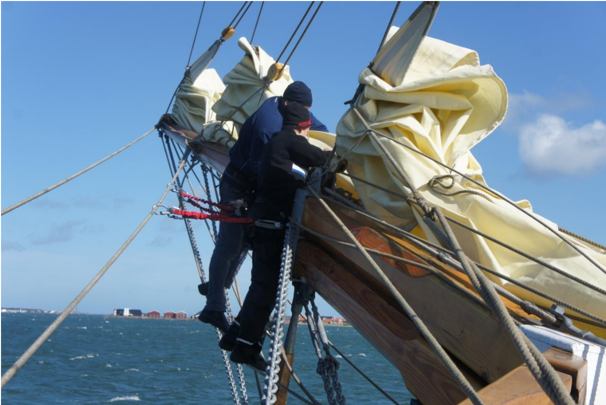
At gå ud på bovsprydet svarer til at gå i riggen – her ser du, hvordan sikkerhedslinen kan fastgøres
