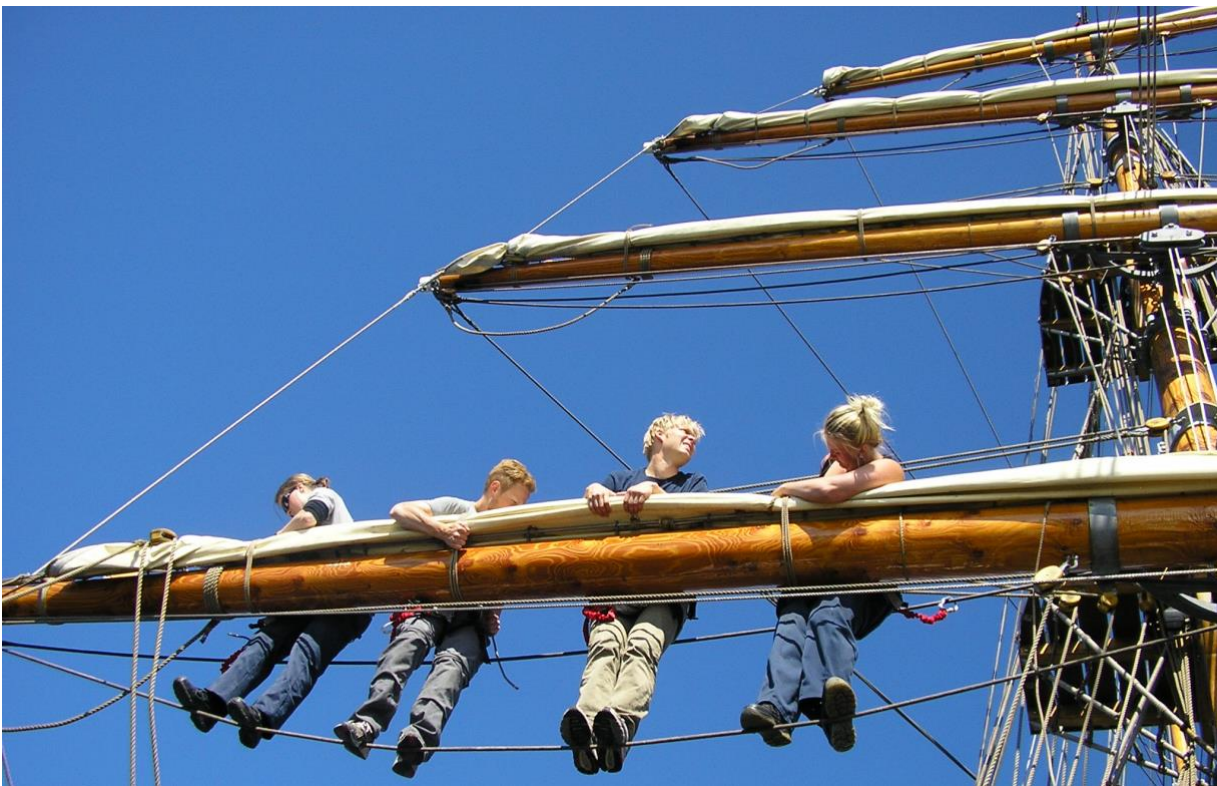
Bemærk at riggasterne har korrekt fodtøj på, står rigtigt i fodperten og har sikkerhedslinen fastgjort i rygperten
